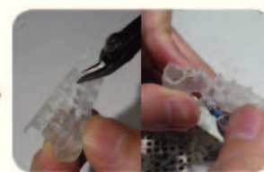
Удаление каркаса и доводка
